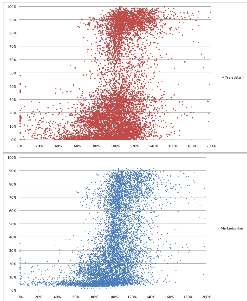
Figur 10. Sammenhængen mellem spotpris og elproduktion for decentrale kraftvarmeværker under 5 MW i Vestjylland. Øverste figur viser værker på treledstariffen og nederste figur viser værker på markedsvilkår. X-aksen er timens spotpris delt med et 24-timers løbende gennemsnit (12 timer før og efter). Dette mål kan være relevant, når værket ønsker at afsætte en vis mængde el i de dyreste timer. Y-aksen viser den samlede produktion i forhold til installeret effekt.
