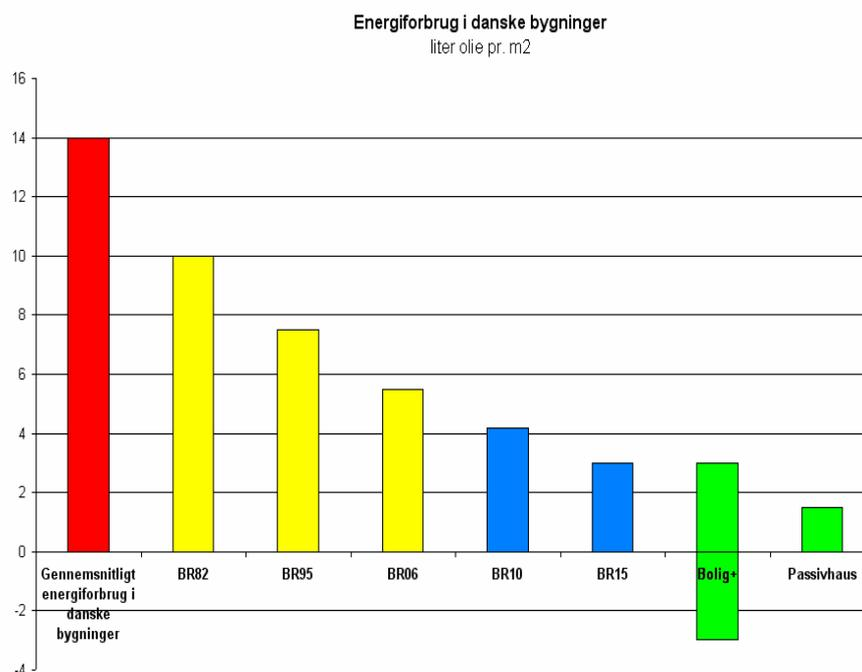
Figur 11: Energiforbrug i danske bygninger. Det gennemsnitlige danske byggeri sammenlignet med kravene i bygningsreglementerne fra 1982, 1995 og 2006. Endvidere fremgår mulige stramninger til bygningsreglementerne for 2010 og 2015 (lavenergiklasse 2 og 1), samt lavenergikoncepterne Bolig+<sup>21</sup> og Passivhaus.
