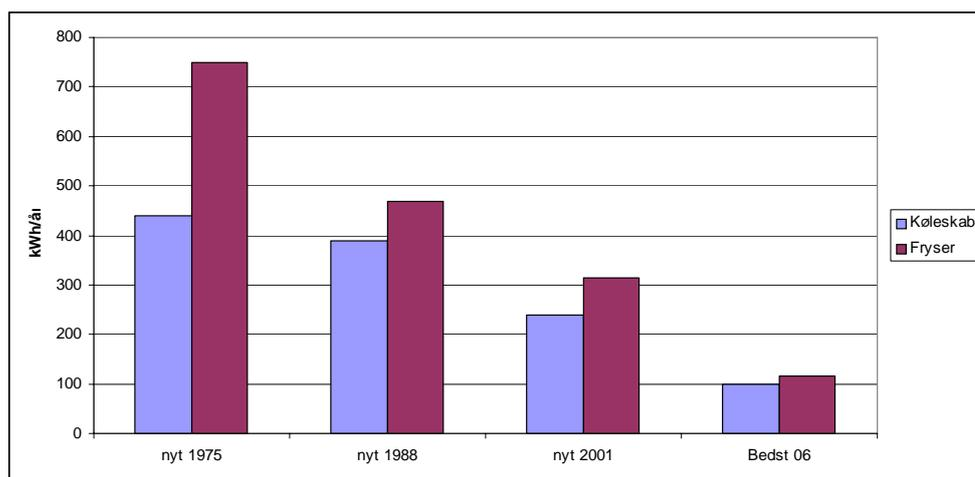
Figur 10: Der er store potentialer i, at forbrugerne anvender de mest effektive teknologier. Eksempel: Energiforbrug fra nye og gamle køleskabe og fryserne.
